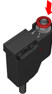
Abbildung 18. Neue Kunststoffscheibe installieren
